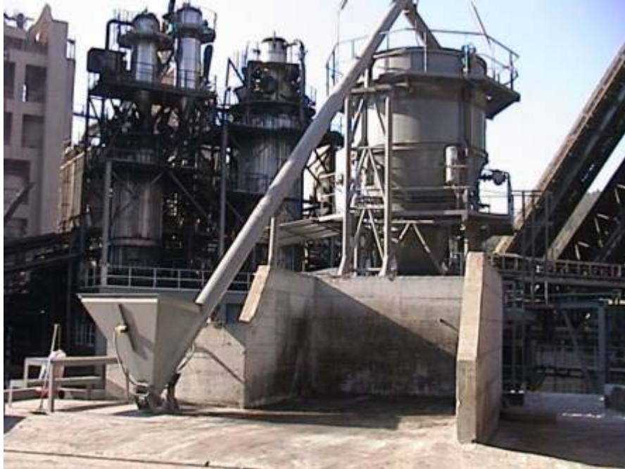
Foto 3 - Depósito de carga, parafuso de elevação e tremonha com doseador gravimétrico
