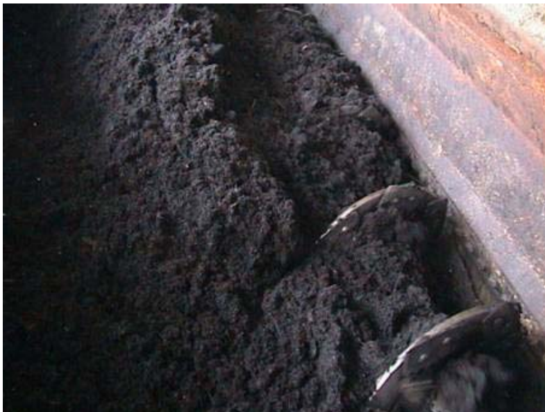
Foto 2b – Homogeneização em misturador de parafusos
