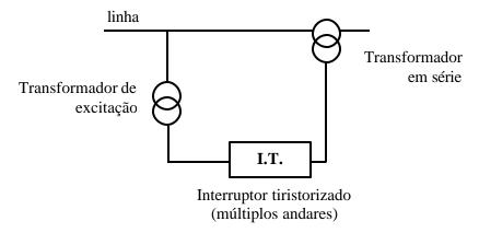
Controlador Unificado de Potência (UPFC – Unified Power Flow Controller)
