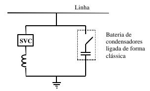
O funcionamento é semelhante ao dos conjuntos clássicos, mas há algumas vantagens no funcionamento dinâmico. Há sistemas destes desde o fim dos anos 1970.
