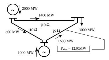
Admita-se que a linha que transporta 1600 MW está em sobrecarga, pois o seu limite máximo é de 1250 MW. Nesta situação, ou se altera o despacho de geração ou se introduz uma correcção nos ângulos das tensões por forma a encaminhar o fluxo de potência do modo pretendido (por forma a evitar colocar linhas em sobrecarga).
