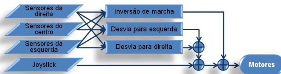
Figura 72: Arquitectura de subsunção utilizada no controlo de desvio de obstáculo
