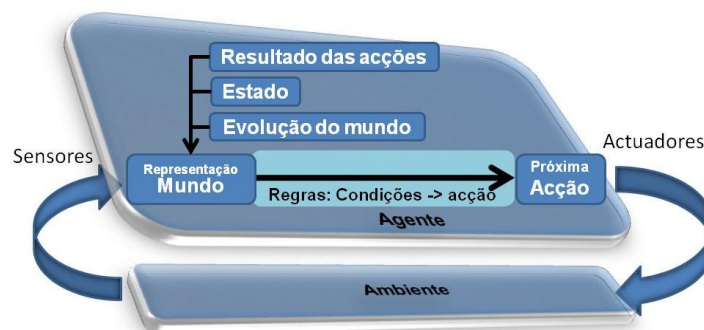
Figura 16: Diagrama esquemático de um agente reactivo com estado interno
