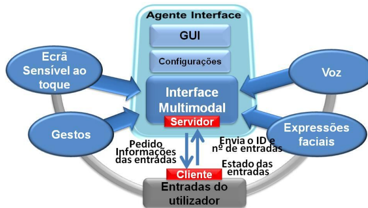
Figura 73: Arquitectura do módulo MMI
