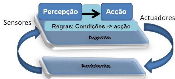
Figura 15: Diagrama esquemático de um agente reactivo
