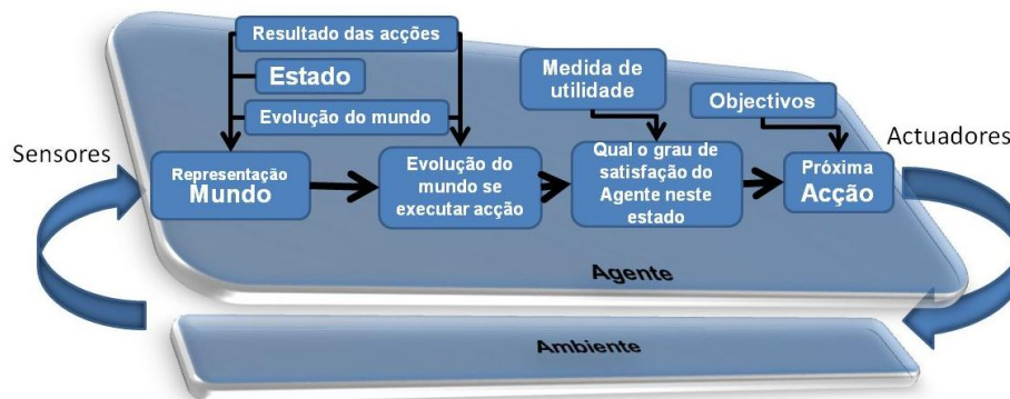
Figura 18: Diagrama esquemático de um agente baseado em utilidades
