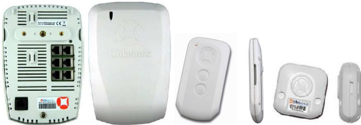
Figura 66: Sistema Ubisense: Antena, tag fina e tag compacta
