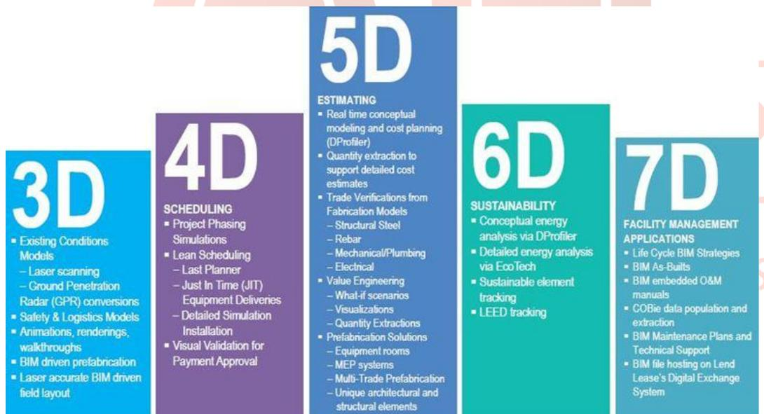
Fig2 Diferentes dimensões dos BIM
