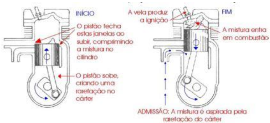
Fig.15 – Primeiro tempo do processo que ocorre em motores de dois tempos: compressão/ admissão;
