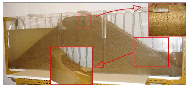
Figura 13. Danos no coroamento e paramento de jusante.
