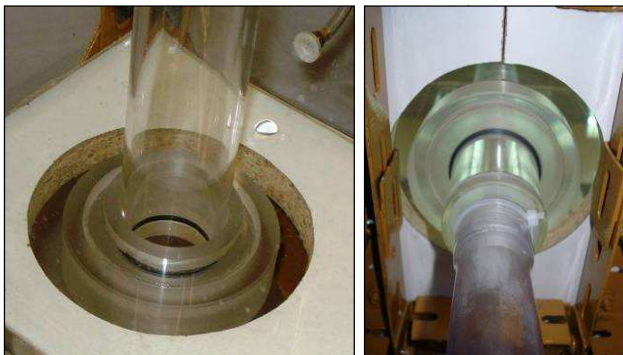
Figura 2. Tubo de controlo do nível de água - vistas superior (à esquerda) e inferior do sistema de ajuste da altura.
